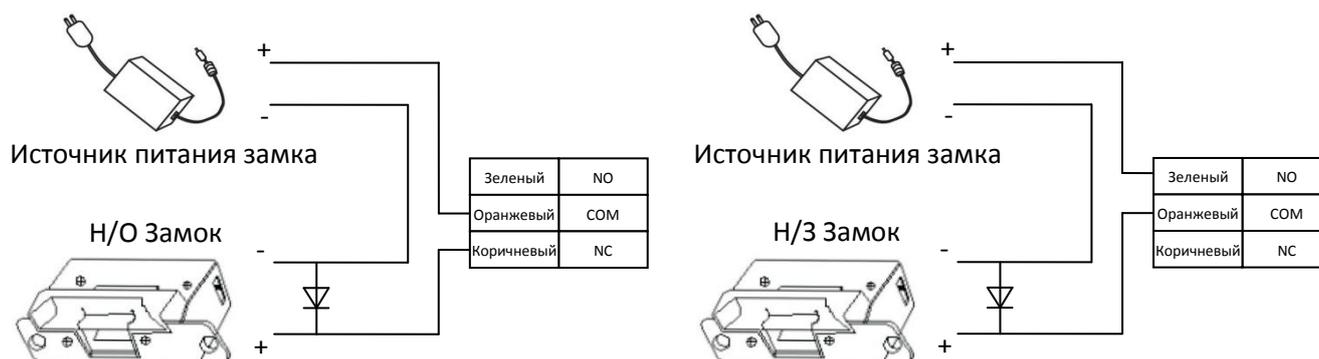
Панели вызова имеют возможность разблокировки замка НЗ типа, например, серии ST-RL073 без использования дополнительного источника питания.
