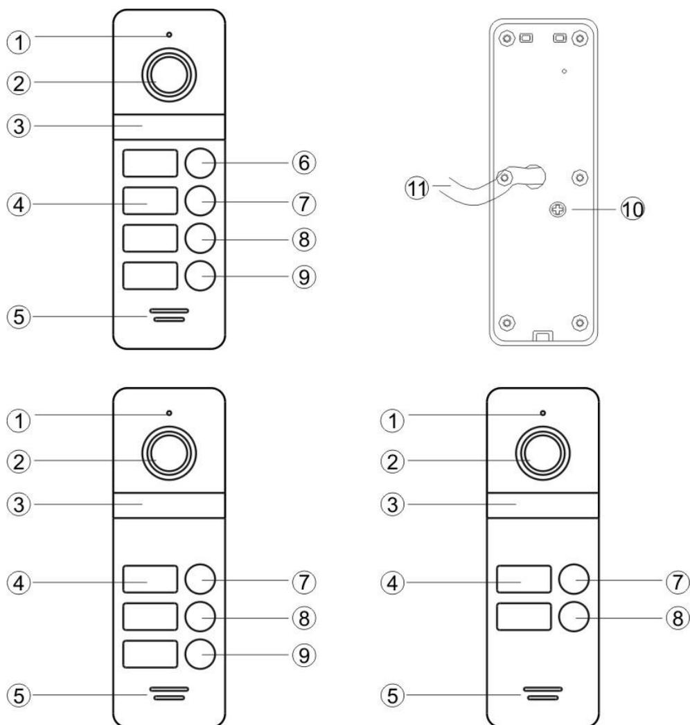
**1 – Микрофон** используется для трансляции звука с панели вызова.
